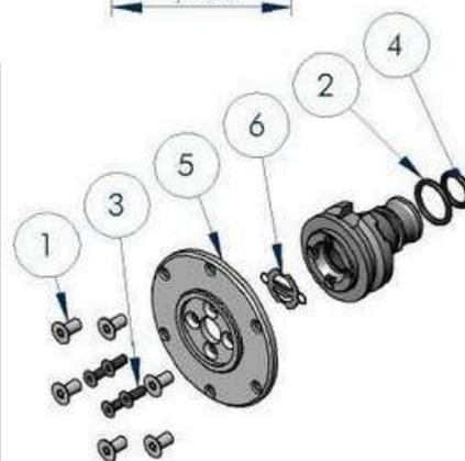
**CÔNE PORTE-OUTILS RA40 - ATTACHE 1/2 GAZ + CENTRAGE Ø45**
