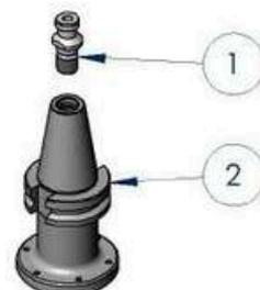
**CÔNE PORTE-OUTILS BT50 - ATTACHE ALESAGE Ø60 (6 TROUS/Ø100) - L300 - TIRETTE Ø21**
