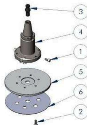
**CÔNE PORTE-OUTILS BT40 - L250 - FIXATION VELCRO RIGIDE Ø200 - TIRETTE Ø15**
