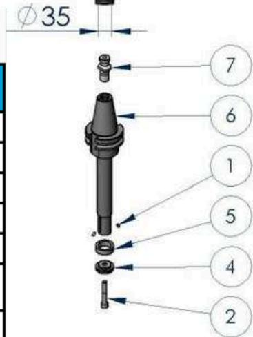
**CÔNE PORTE-OUTILS BT50 - ATTACHE 1/2 GAZ + ALESAGE Ø35 - L500 - TIRETTE Ø21**
