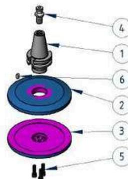
**CÔNE PORTE-OUTILS BT50 POUR DISQUE ALESAGE Ø100 - FLASQUE Ø255 - TIRETTE Ø21**
