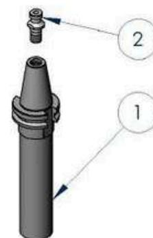
**CÔNE PORTE-OUTILS BT50 - ATTACHE 1/2 GAZ - L98 - TIRETTE Ø21**
