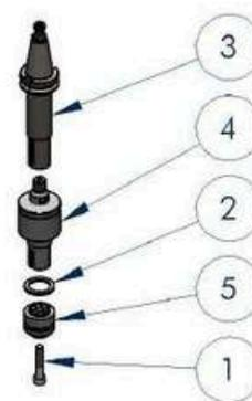
**CÔNE PORTE-OUTILS BT40 AVEC CARDAN - ATTACHE ESCARGOT Ø130 - TIRETTE Ø15**
