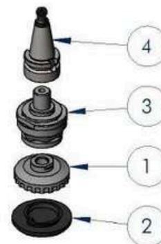
**CÔNE PORTE-OUTILS BT40 AVEC PLATEAU VELCRO SOUPLE Ø130 - TIRETTE Ø15**
